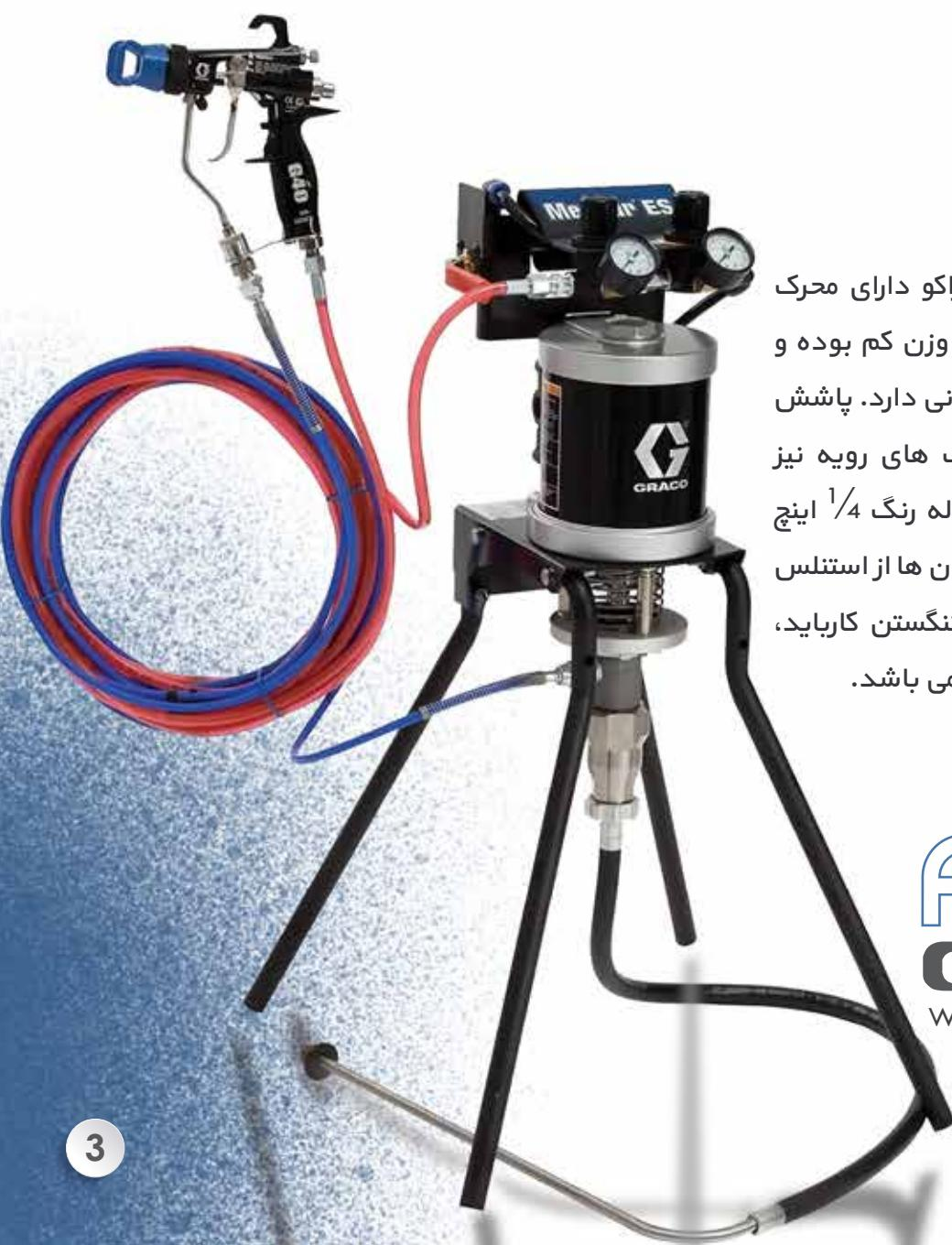
این سری از پمپ رنگ پاش گرaco دارای محرك بادی می باشد. کوچک و دارای وزن کم بوده و برای ظرفیت های کم کاربرد فراوانی دارد. پاشش بسیار دقیق داشته و برای رنگ های رویه نیز بسیار مناسب می باشد. قطر لوله رنگ  $\frac{1}{4}$  اینچ می باشد. جنس سیلندر و پیستون ها از استنلس استیل و دیگر قطعات پمپ از تنگستن کاریابید، تفلون، استال، چرم و پلی اتیلن می باشد.
